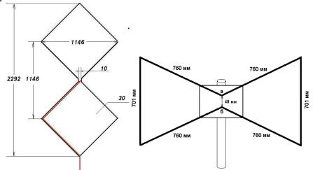
Эти антенны легко повторяются из медного или алюминиевого провода, если сделать опорную конструкцию в виде крестовины или двойной крестовины, из деревянных брусков или сварить из полипропиленовых труб. Трубы диаметром 25 мм дают довольно таки прочную конструкцию и не боятся природных явлений.
