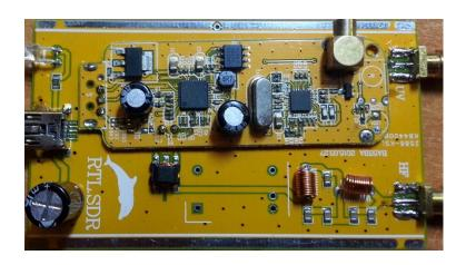
Мы видим плату DVB-тюнера установленную на плате приемника и небольшой набор деталей, ниже этой платы. А там простой ФНЧ, для КВ-диапазона и трансформатор. На этой фотографии не очень хорошо видно, куда подключен трансформатор, но можно поискать фотографии других подобных
