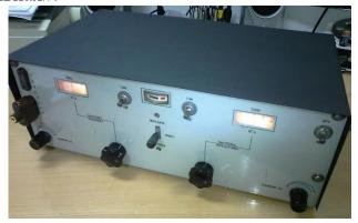
У такой радиостанции приемник и передатчик настраивались на частоту отдельными ручками и для синхронизации частоты, для передачи, использовалась настройка на гетеродин передатчика, методом «нулевых биений». Позже, радиостанции стали строить по трансиверной схеме, где часть узлов приемника и передатчика были общими. Так использование общего гетеродина, делало передатчик настроенным сразу на ту частоту, которую принимал приемник в данный момент.
