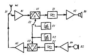
Позже, придумали как использовать одни и те-же каскады усиления и фильтрации в режиме приема и передачи, так называемые «реверсивные» каскады трансивера.
