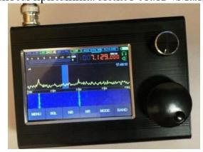
Он имеет графический сенсорный дисплей и позволяет принимать радиостанции с любым видом модуляции в диапазоне частот от 50 кГц до 2 ГГц. Приемник имеет большое количество настроек, но и соответствующую цену. Проект приемника «Малахит DSP» является открытым и его схемы доступны всем желающим, для самостоятельной сборки. Этим
