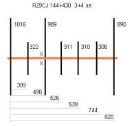
Траверса дизлектрическая Элементы алюм ф 4 мм Кабель 50 Ом Запитана одним кабелем в точках X X 144,500 усиление G=5,32 КСВ=1,01 КСВ на 144=1,03 КСВ на 146=1,19 435,0 усиление G=6,73 КСВ=1,01 КСВ на 430=1,95 КСВ на 440=1,4
