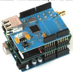
Такие платы расширения называют «шилдами» (shield). На Arduino UNO установлен стабилизатор напряжения, с током до 600 mA, что позволяет питать собранное устройство напряжением от 7 до 12 вольт.
