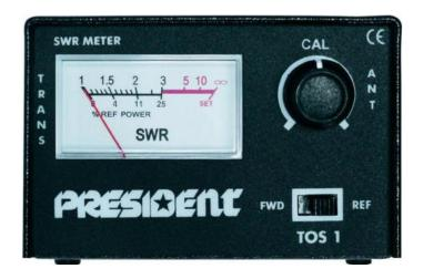
На передней панели выведен переключатель FWD-REF (Прямой – Отраженный сигнал) и ручка регулировки, которая у нас на схеме отображена в виде подстроечного резистора R1. Порядок работы с измерителем КСВ подобного типа, следующий:
