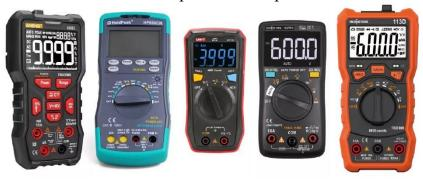
Так же не стоит брать мультиметр с несъемными проводами, поскольку при их повреждении, усложняется их замена. К недостаткам недорогих мультиметров можно отнести невысокое качество идущих в комплекте проводов с щупами. Поэтому по возможности, приобретите более длинные провода в силиконовой изоляции.
