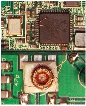
Как видим, сигнал с трансформатора заведен напрямую на вход АЦП. А с учетом, что RTL2832U, в нашем случае, имеет частоты работы 28.8 МГц, то мы можем надеяться на оцифровывание диапазона от 0 до 28.8 МГц, т.е. почти всего коротковолнового спектра. Правда остается непокрытым участок от 28.8 до 42 МГц, которые уже может принимать R820T2, но китайские производители уверяют, что он худо-бедно начинает работать с 25 МГц, а значит все в порядке.
