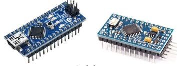
Это менее габаритные варианты Arduino, которые можно использовать на печатных палатах. Да и на монтажной плате, такой вариант микроконтроллера использовать довольно таки удобно. Arduino Pro Mini короче чем Arduino Nano, за счет того, что с платы убрана микросхема USB-интерфейса и для программирования Arduino Pro Mini, необходимо подключать внешний переходник, что может быть неудобно при отладке устройства.
