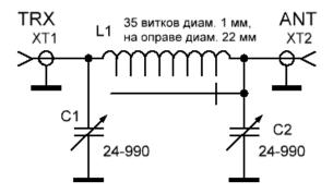
Если вы не планируете работать на нерезонансных антеннах, на диапазонах 160 и 80 метров, то такое согласующее устройство наверняка справится с вашими антеннами. Тем более, что все его компоненты замечательно поместятся в корпус блока питания от компьютера [4].
