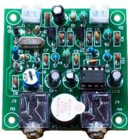
Как видите, на плате также отсутствуют разъемы подключения блока питания и антенны, предполагается, что вы будете использовать внешние разъемы для этих целей. Из-за дополнительной крупной детали (зуммера) и отсутствия разъемов, компоновка платы немного отличается. Кстати, зуммер отключить невозможно.
