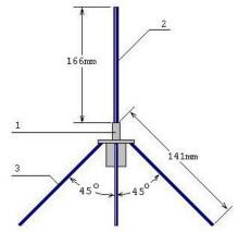
Такую антенну можно изготовить из провода диаметром 1-2 мм, прямо на антенном разъеме [2]. На крышу ее конечно в таком исполнении не вытащить, но на балконе, если он не имеет металлических конструкций, или за его пределами разместить вполне реально. Такая антенна однозначно будет работать лучше, чем «штатная» антенна портативной радиостанции.
