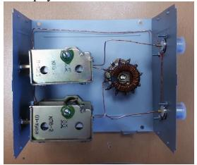
Стоит заметить, что большинство старых радиолюбителей считают такую схему согласующего устройства самой лучшей. Это вероятнее всего связано с тем, что использование «П-контура» на выходе лампового передатчика, позволяло эффективно подавлять гармоники, которыми был богат сигнал ламповых усилителей [5]. Заодно такой «фильтр» хорошо справлялся с согласованием импеданса применяемых радиолюбителями антенн.
