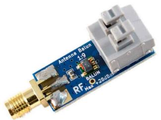
Но можно изготовить такой трансформатор самостоятельно. Для этого необходимо взять любое доступное ферритовое кольцо из любого радиоприемника. Сложить вместе три провода и намотать на кольце несколько витков, после чего соединить их согласно прилагаемой схеме.
