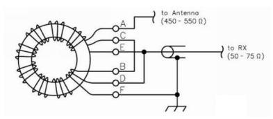
Теперь, подключив свою антенну через данный трансформатор, вы услышите, насколько более мощно звучат сигналы радиостанций.
