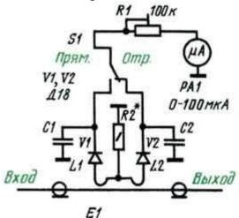
В схеме виден проходящий «насквозь» проводник с высокочастотным сигналом, от передатчика к антенне. В виде трансформатора реализованы две катушки, включенные последовательно, средняя точка которых соединена с «общим проводом». Далее сигнал выпрямляется диодами и подается на стрелочный индикатор. По такой схеме реализовано много, выпускаемых промышленностью, простых измерителей мощности и КСВ.
