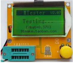
Несмотря на кажущуюся простоту, прибор умеет не только измерять сопротивления, индуктивности и емкости. Он умеет определять диоды, тиристоры и транзисторы, их тип, проводимость и основные параметры.
