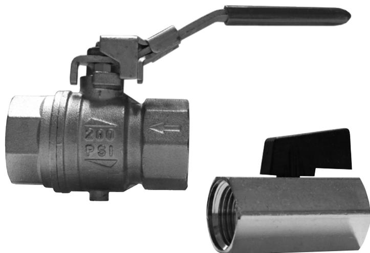
Шаровые краны предназначены для управления потоками сжатого воздуха, воды и минерального масла. Корпус крана Серии S93 имеет дренажное отверстие с резьбой M5, предназначенное для сброса воздуха из технологического оборудования при закрытии крана. Иначе, отверстие должно быть
